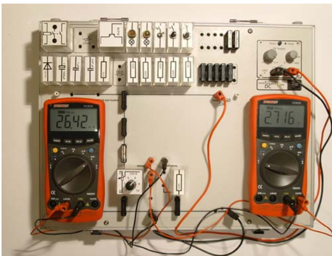
Abb. 1: Schüleraktiver Experimentalunterricht: Spannungsteiler 4
